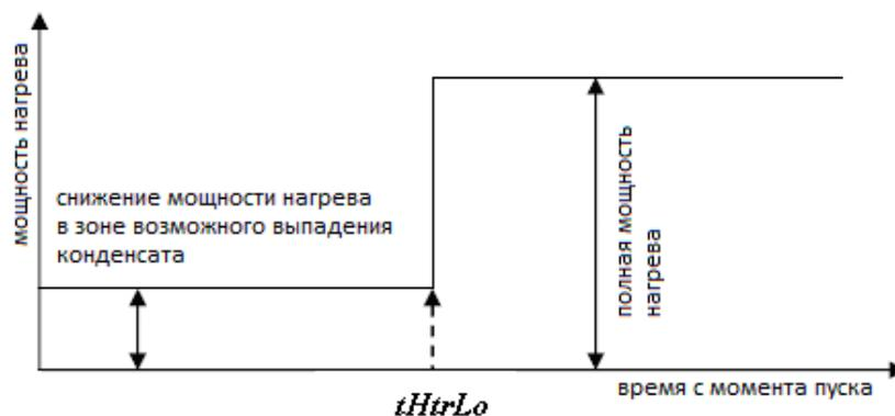
Управление мощностью задается соотношением времени включенного состояния нагревателя  $t_{HtrOn}$  (неизменяемая константа 0,1 с) ко времени выключенного состояния  $t_{HtrOff}$ , которое вычисляется на базе требуемого действующего значения напряжения питания нагревателя (справочная величина, индивидуальная для различных типов датчиков) по формуле:
