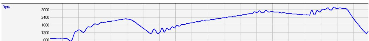
Для подавления трансмиссионных колебаний используется отдельный алгоритм (группа ***Ignition->Anti-Jerk***). Алгоритм обеспечивает динамическое воздействие на величину УОЗ, в результате чего крутящий момент стабилизируется, снижая интенсивность колебаний. Включение алгоритма осуществляется заданием `swAntiJerk=ON`. Для использования алгоритма обязательно наличие датчика скорости (или получение информации о скорости автомобиля через CAN-шину).
